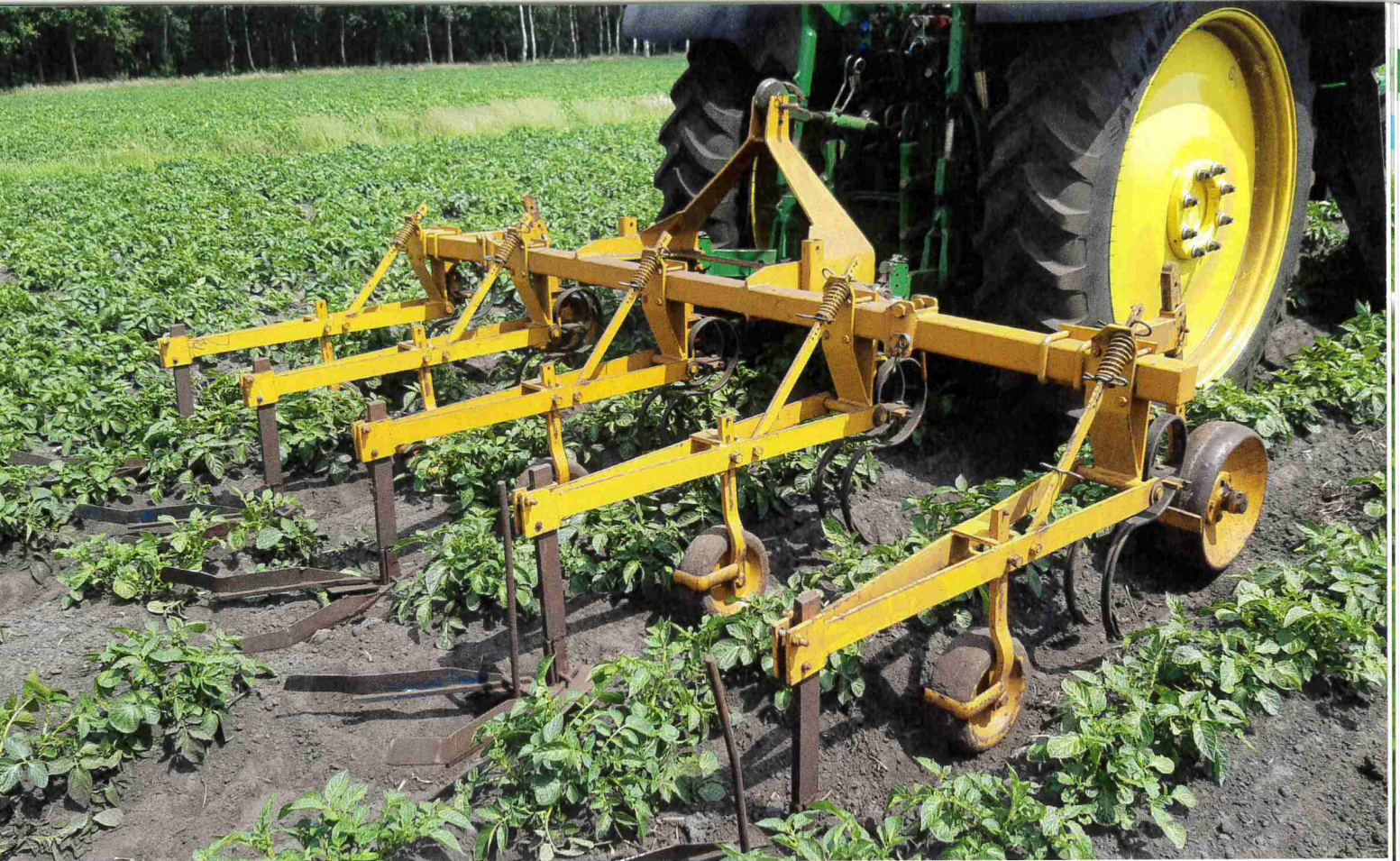
De schoffelbalk met oplopende schoffels die voor de demo in aardappelen gebruikt is. De demo laat zien dat met eenvoudige bestaande techniek onkruid goed mechanisch te bestrijden is. Dat verlaagt de drempel voor telers om eens wat uit te proberen. FOTO:HLBBV
