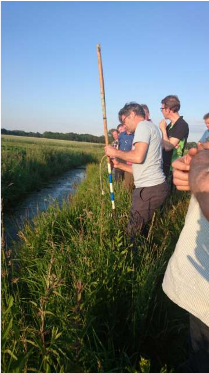
meten van waterdiepte met een handige hark
